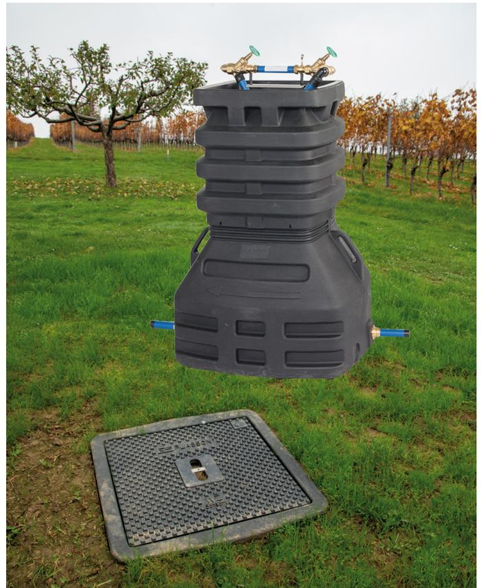
Der PLASSON Wasserzählerschacht ist als nicht begehbare Schachtbauwerk für den Einbau im Rohrgraben konzipiert. Er bietet die ideale Lösung für Endabnehmer von Trinkwasser, bei denen der Wasserzähler nicht im Gebäude untergebracht werden kann.
